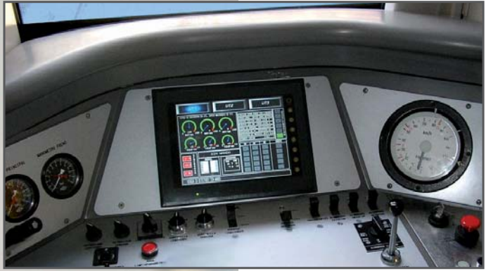
Control y mando de tracción Traction control and Driver screen
